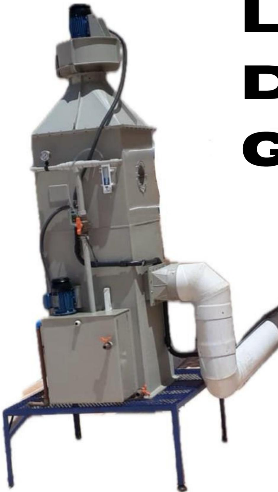
O lavador de gases na capela de exaustão remove partículas e gases nocivos do ar, utilizando água ou líquidos para lavar e capturar impurezas antes da liberação no ambiente externo. Essa tecnologia reduz a poluição do ar, protege o meio ambiente e promove um ambiente de trabalho mais seguro.
