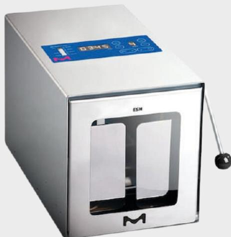
É usado para a homogeneização de alimentos e amostras por meio de pás massageadoras que agem no interior do equipamento, fazendo com que a amostra receba movimentos constantes misturando-as por um tempo pré-determinado. Ele é indicado para laboratórios alimentícios, farmacêuticos, cosméticos, ambientais e outros.
