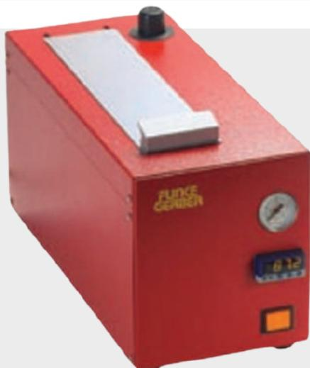
Indicado pelo MAPA para atender a norma ISO 5537, o Secador de Referência RD8 mede o teor de umidade em leite em pó. Oito amostras de leite em pó podem ser analisadas simultaneamente.
